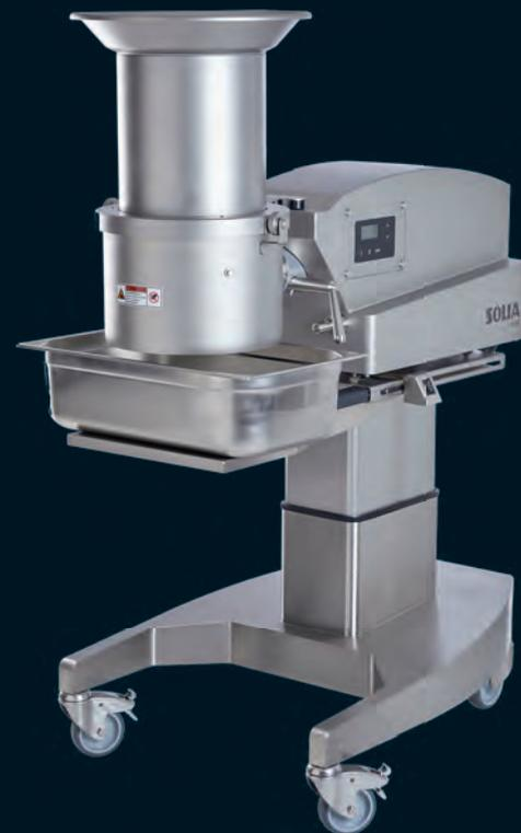
M 50 höhenverstellbares Fahrgestell mit 2-Kammer-Aufsatz
