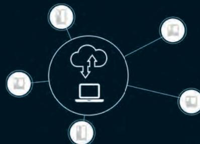
Ihr Gerät kommuniziert über ein Gateway mit der MKN Connected Kitchen Cloud. Mit Hilfe Ihres Endgerätes (PC oder Tablet) greifen sie mittels Browser auf die Cloud zu.
