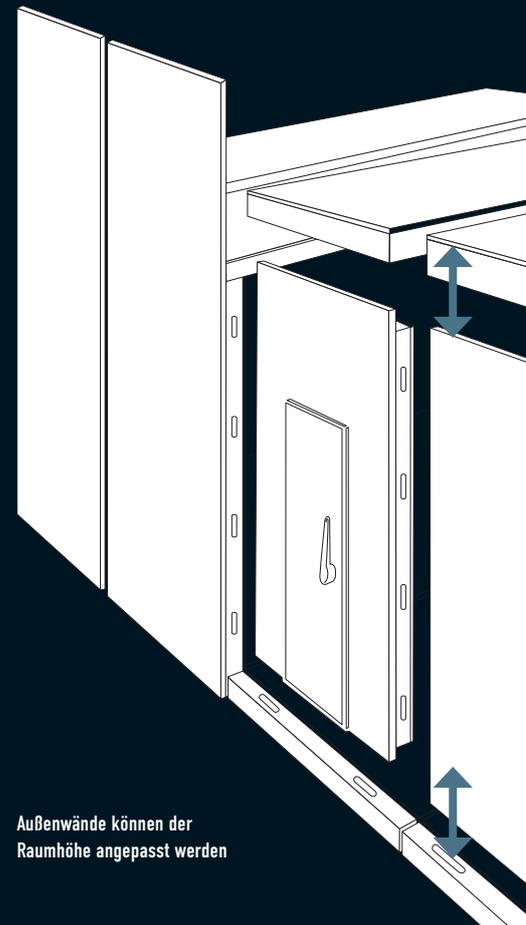
Außenwände können der Raumhöhe angepasst werden
